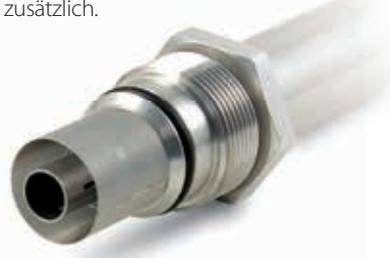
Auch die Serie E2VxxCS100 unterstützt einen Metallfilter von großer Kapazität (optional, Code E2VFIL0100), der vor dem Verlöten des Ventils im Kreislauf installiert werden kann.
